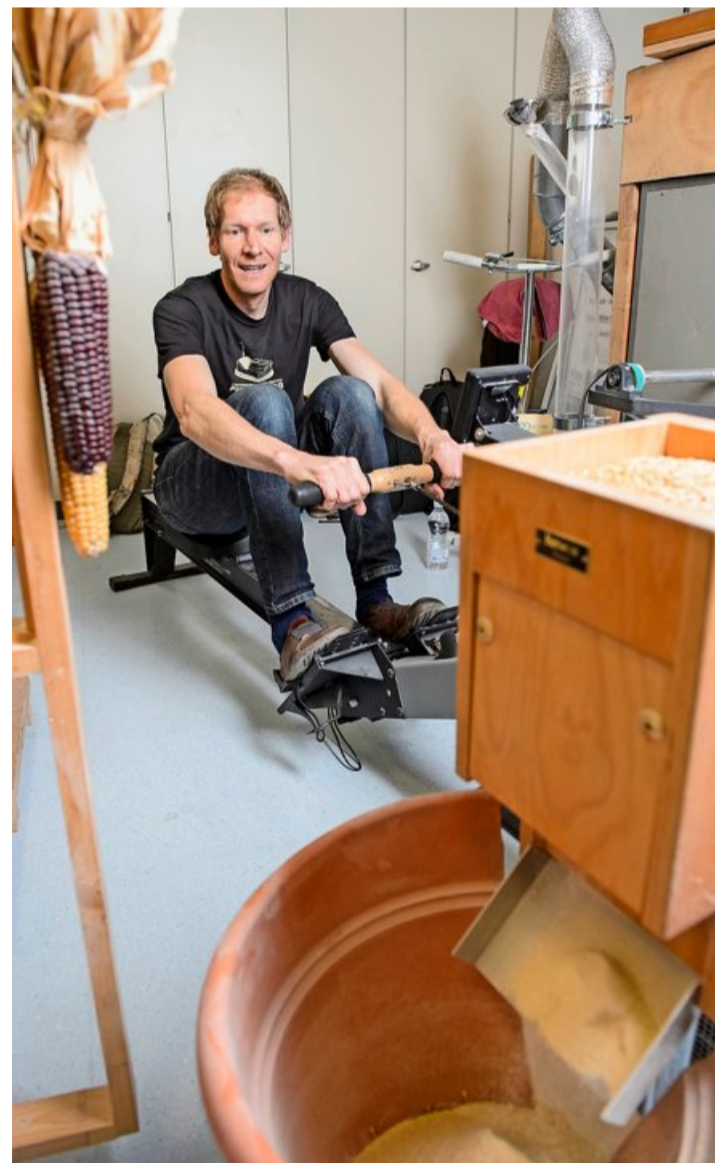
Thomas Wieland rudert in seinem Fitnesscenter und verwandelt damit gleichzeitig Maiskörner zu Polentagriess.
